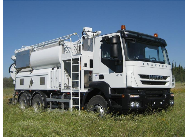
Unidad móvil de fabricación de explosivos (MEMU)
