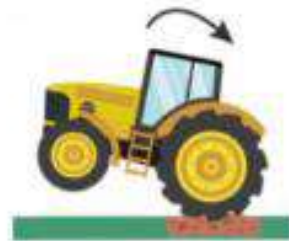
Bloqueo de las ruedas traseras
