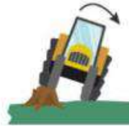
Irregularidad del terreno
