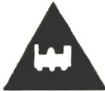
Paso a nivel sin barrera
